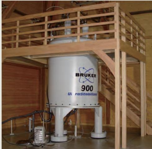
고자기장 자기공명장치(High Field-Nuclear Magnetic Resonance)는 생체분자 입체구조 규명 및 신약개발 연구에 필요한 핵심 장비이며, 현재, 오창센터에 설치해 국가적 공동활용 연구장비로 활용하고 있다.
