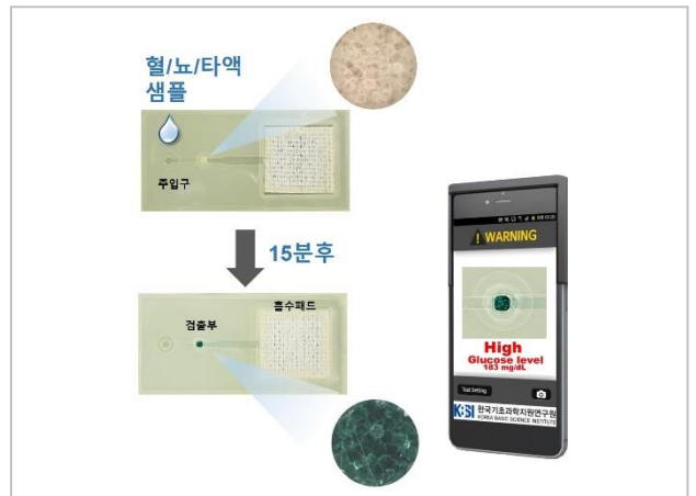
[그림2] 혈액, 소변, 타액 등 다양한 체액 당 분석 및 결과 판독
