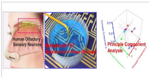
[그림 2] 복잡한 인간후각시스템을 그래핀 마이크로 패턴 전계효과 트랜지스 기술로 재현하였으며, 주성분 분석(principle component analysis PCA)법을 통하여 다중 검출 데이터를 분석하였음
