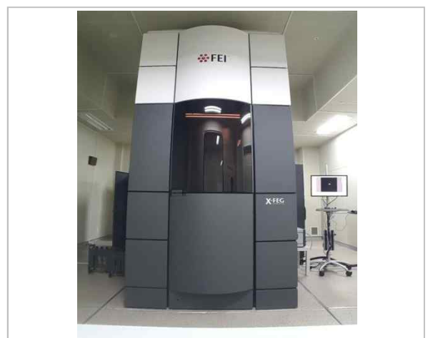
[그림3] KBSI 서울센터 단색전자빔 이중수차보정 투과전자현미경
