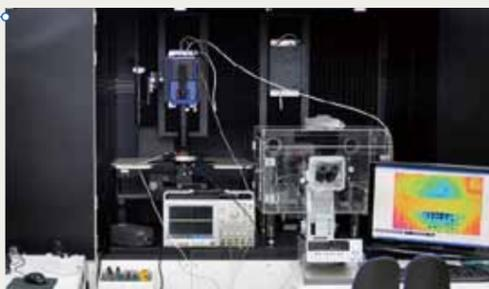
KBSI가 개발한 '초정밀 열영상현미경'은 마이크로 크기의 시료로부터 방사되는 극소량의 적외선을 검출해 절대온도 분포를 측정하고 실시간 열영상을 형성해 시료의 열적 특성을 비접촉, 비파괴 식으로 분석이 가능한 시스템이었다. 또한, 시료의 열 특성을 이용해 분석이 이루어지는 새로운 개념의 분석장비로 적외선열화상 장치와 현미경을 결합시킨 형태였다.
