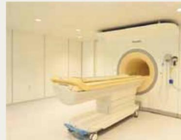
연구용 휴먼 7 T MRI 시스템(7 Tesla Magnetic Resonance Imaging)은 KBSI가 보유한 국가적 공동활용 연구장비로, 협력을 통한 융합 연구를 수행하고 있다. 이 장비는 상용화된 최고자장 기기로, 강력한 외부자장과 라디오파를 이용해 인체 물질의 핵자기공명현상을 일으켜 원자핵의 밀도 및 물리학적 특성을 영상화하는 진단용 촬영장치다. 상용화된 1.5 T 또는 3 T MRI에 비해 감도가 좋아서 초고해상도(~0.2 mm) 영상촬영이 가능해, 뇌의 세부구조, 기능영상, 대사체 분석, 척추 등 근골격계 연구에 활용할 수 있다.
