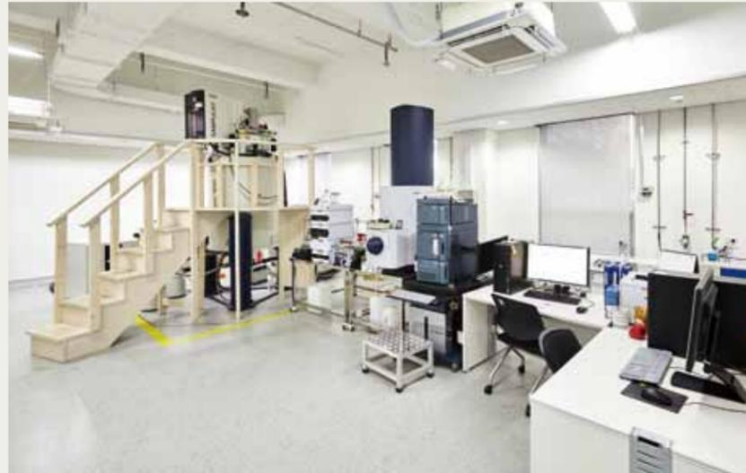
핵자기공명분광기-질량분석기시스템(SPE-800 MHz NMR-MS System)은 LC, NMR, MS가 온라인으로 연결된 하이프네티드 시스템(Hyphenated system)으로서, 혼합물을 LC로 분리 후 고감도 800 MHz NMR로 화합물의 구조를 확인하는 대사체/천연물 분야 특화 운영 장비이다.
