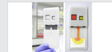
시료, 시약의 순차적인 주입을 자동화한 사용자친화적 진단키트 플랫폼 User-friendly diagnostic kit allowing the automatic sequential delivery of sample and reagent.
