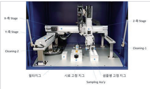
다목적 미세영역 자동시료채취장치 개발 Development of a multipurpose automatic sampling device with a fine scale
