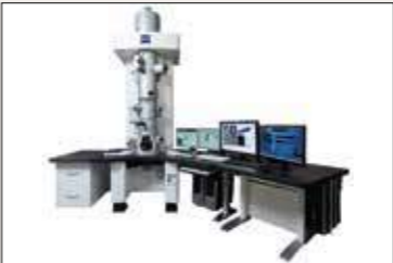
수차보정 에너지여과 투과전자현미경 Ultra-Corrected Energy Filtered Transmission Electron Microscope(UC-EF-TEM)
