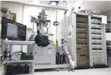
30kV 보급형 투과전자현미경 (텅스텐 / CeB 6 ) 30kV low-end TEM (W / CeB 6 Gun)
