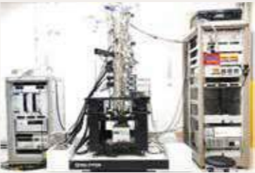
30kV 보급형 투과전자현미경 (전계 방출 전자총) 30kV low-end TEM (Field emission electron gun)
