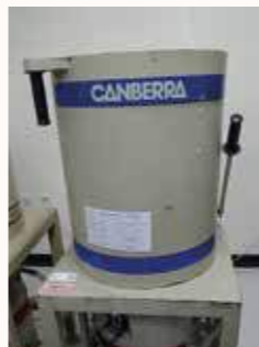
고순도 게르마늄 감마선 검출기 High Purity Germanium Gamma Detector (HPGe detector)
