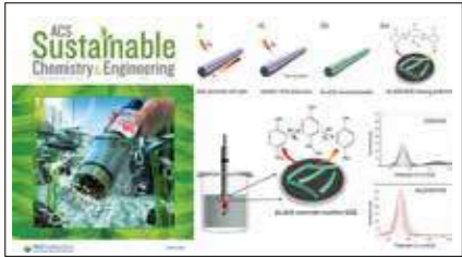
친환경 고감도 독성물질의 검출에 활용 가능한 Au-ZnS 나노구조물질 기반의 전기화학센서
