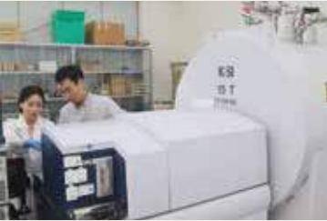
초고분해능 퓨리에변환-이온사이클로트론공명 질량분석장치 Ultra-high resolution 15 T FT-ICR mass spectrometer
