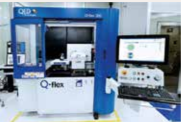
자기유변식 표면형상 보정가공 시스템 Flexible MRF polishing system(Q-flex)
