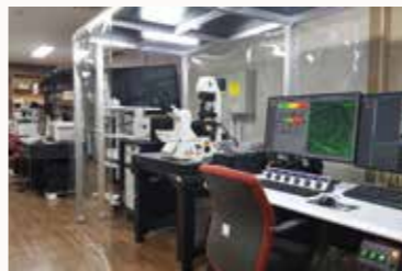
초고분해능 실시간 형광수명 영상현미경 Super-resolution real-time fluorescence lifetime imaging microscope (STED-FLIM)
