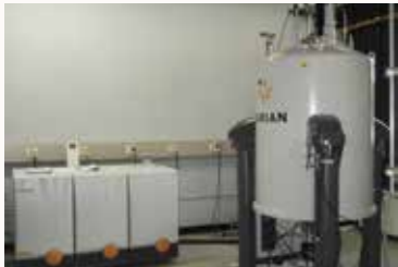
500 MHz 고체 핵자기 공명 분광기 500 MHz Solid State Fourier-Transform Nuclear Magnetic Resonance (FT-NMR) Spectroscopy
