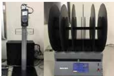
소동물 운동능력 측정 시스템 Small Animal Exercise Performance Measuring System
