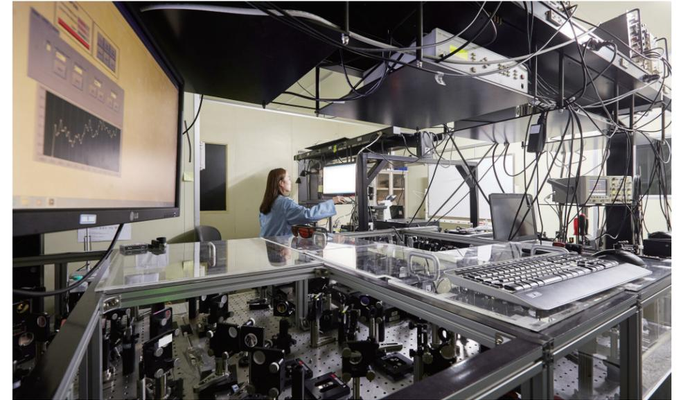
극초단파 레이저 빔을 이용해 분자의 움직임을 펨토초 시간 단위로 분해하여 분석할 수 있는 시스템 장비로 나노재료 등 다양한 물질의 초고속 반응 동역학 규명 연구에 공동 활용하고 있습니다.
