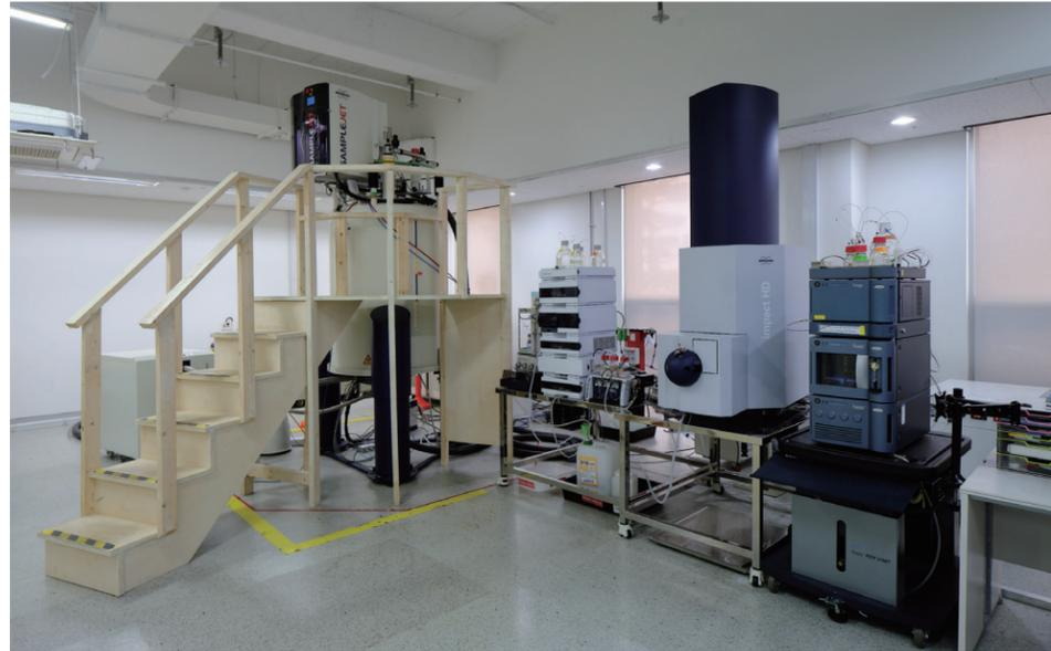
LC, NMR, MS가 온라인 연결된 hyphenated system으로 혼합물을 LC로 분리 후 고감도 800 MHz NMR로 화합물의 구조를 확인하는 대사체/천연물 분야 특화 운영 장비입니다.
