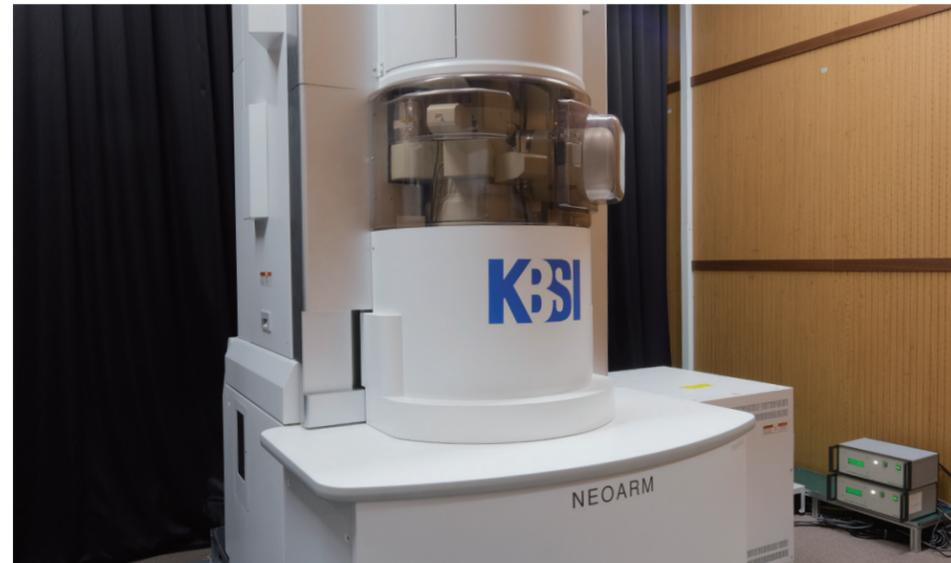
수차보정기와 단색기를 장착한 원자레벨 주사투과전자현미경(STEM) 이미지와 '초고분해능 전자에너지손실분광' 분석법으로 재료의 '원자레벨 구조분석, 전자구조분석' 등 반도체 산화물 및 나노소재 결함 분석 뿐만 아니라, 경우에 따라서는 고분자, 바이오 재료 등에 활용 될 수 있으며 다양한 기초과학 및 융복합 과학분야에 전문 연구지원 장비로 운영되고 있습니다.
